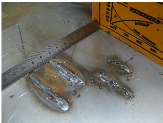
Risultato con MAGNETE TRADIZIONALE AL NEODIMIO su 3 mm di spessore acciaio
